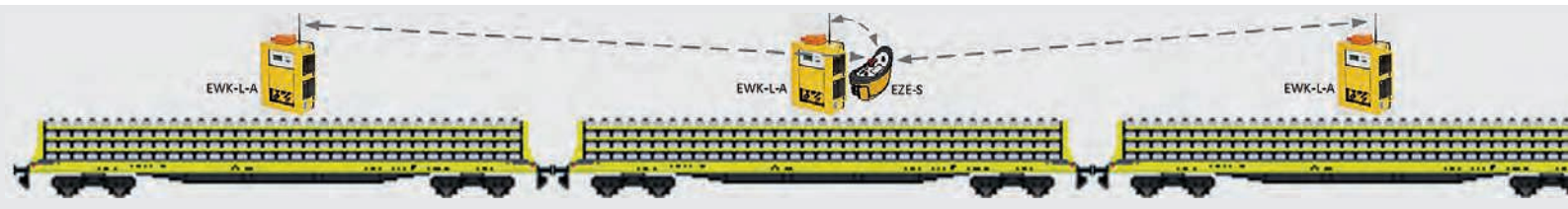
Abb. 7: Schwellenwagen mit angehängten Funkwarnmitteln und einer WG-Zentrale
