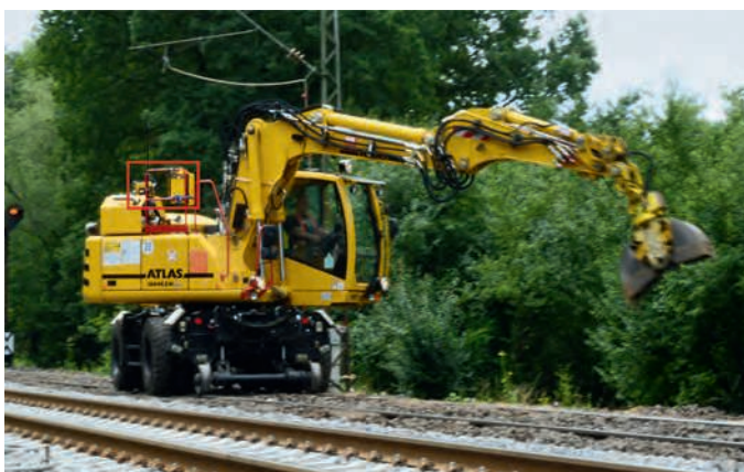
Abb. 5: Zweiwegebagger im Einsatz mit angehängter Warngruppe
